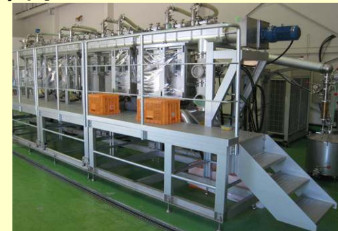
バイオマス再資源化装置
