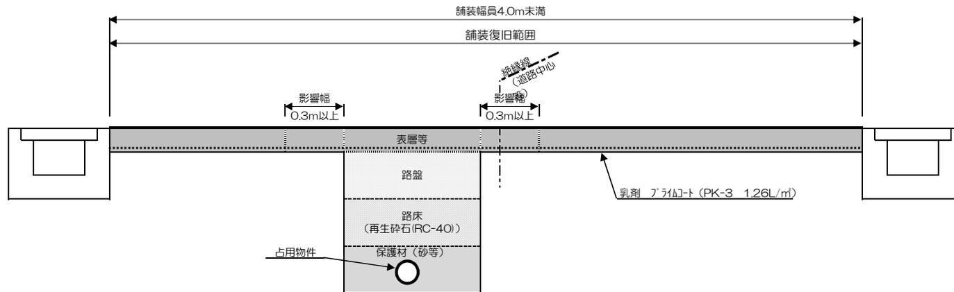
例3) 舗装幅員4.0m以上の道路で、掘削の影響幅から絶縁線（道路中心等）までの距離が1.2m未満の場合は、その区間も含めて復旧
