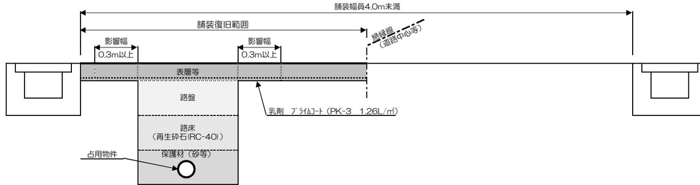
例2) 舗装幅員4.0m未満の道路で、掘削の影響幅が道路中心を超える場合は、全幅復旧
