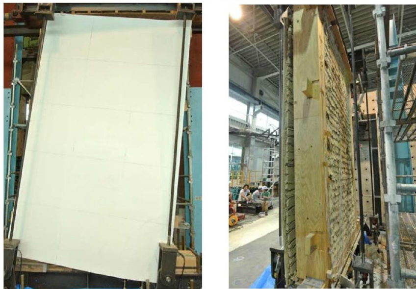
写真5.1 土蔵壁の壊れ方 大壁部分は剥離落下
