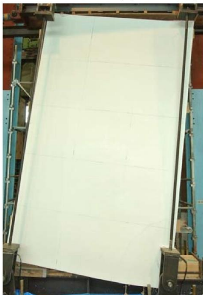
写真5.1 土蔵壁の壊れ方 大壁部分は剥離落下
