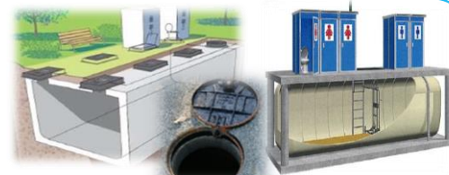
マンホールトイレのイメージ 左図：くみ取り式 右図：FRP製
