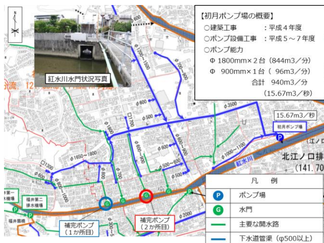
補完ポンプ整備（初月地区）
