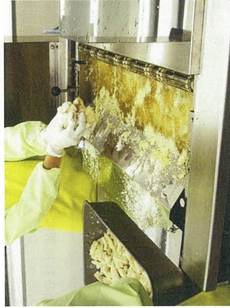
連続式揚物機 投入口
