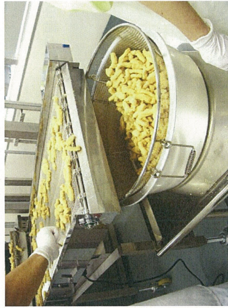
連続式揚物機 出来上がり口
