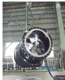
東秦泉寺排水機場に設置した直径800mmのポンプ
