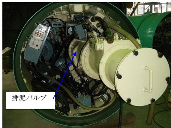
図 5-8 排泥バルブ設置位置写真
