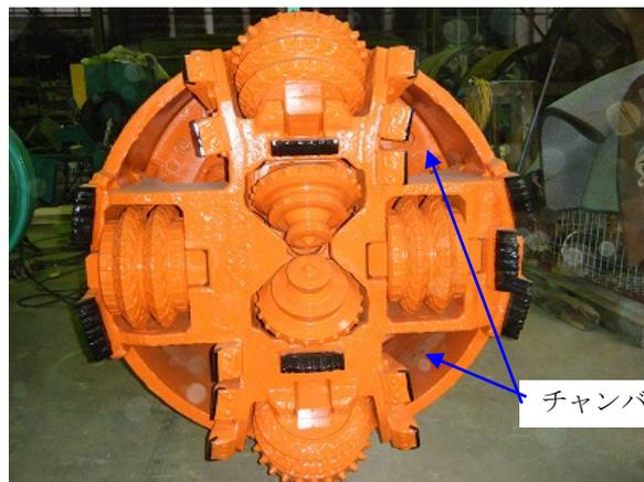
図 5-5 掘進機前面写真(礫破碎型)
