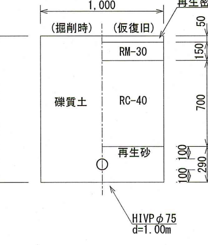
仮設配管栓 φ75取付部 (d=1.00m) (県道車道部) L=2.5m × 2箇所
