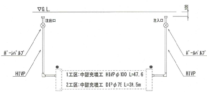
廃止管中詰充填図 S=1:Free
