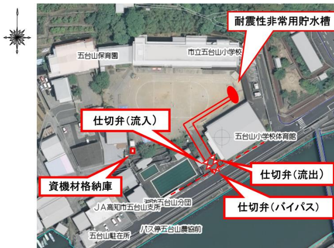
五台山小学校耐震性非常用貯水槽配置状況
