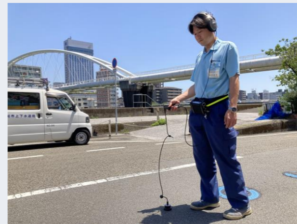
管路管理課 漏水探知器による漏水調査
