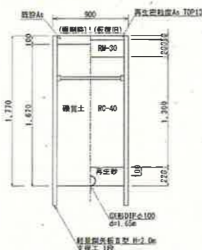
【詳細部②】GX形DIPφ100(d=1.65m) (県道車道部) ΣL=3.2m
