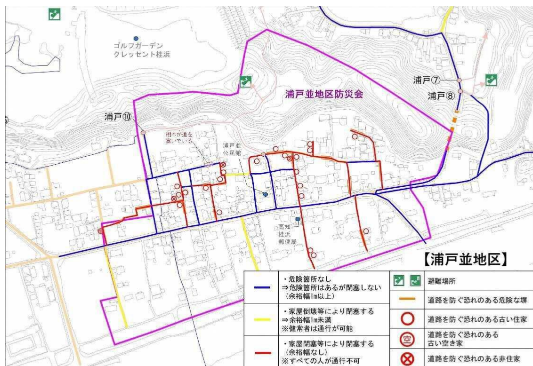
図 6-6 現地点検用図面の一例（浦戸並地区）
