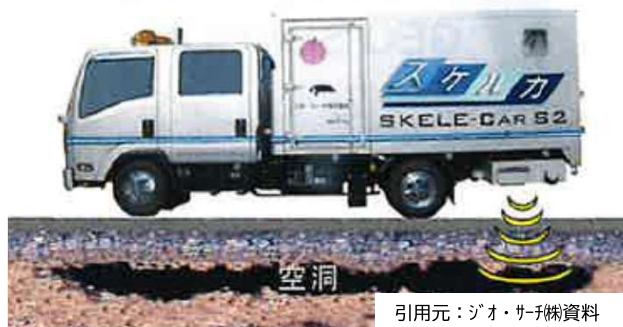
○空洞調査 (特殊車両レーダー探査)
