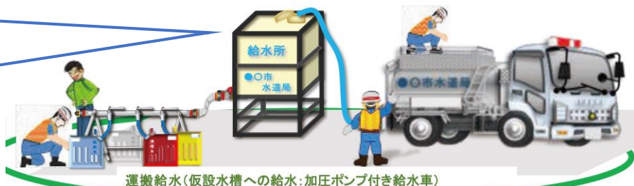
運搬給水(仮設水槽への給水:加圧ポンプ付き給水車)
