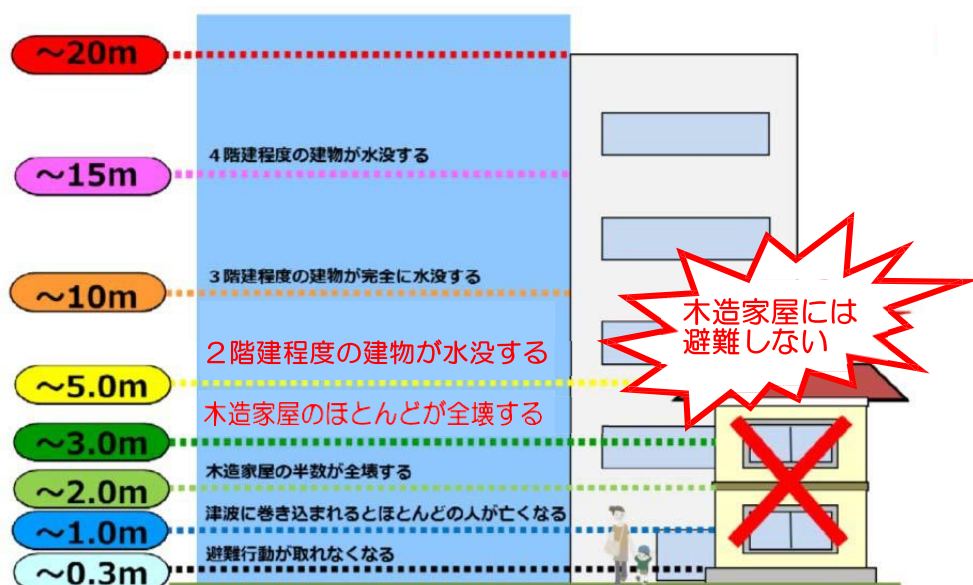
図9 津波浸水深の目安
