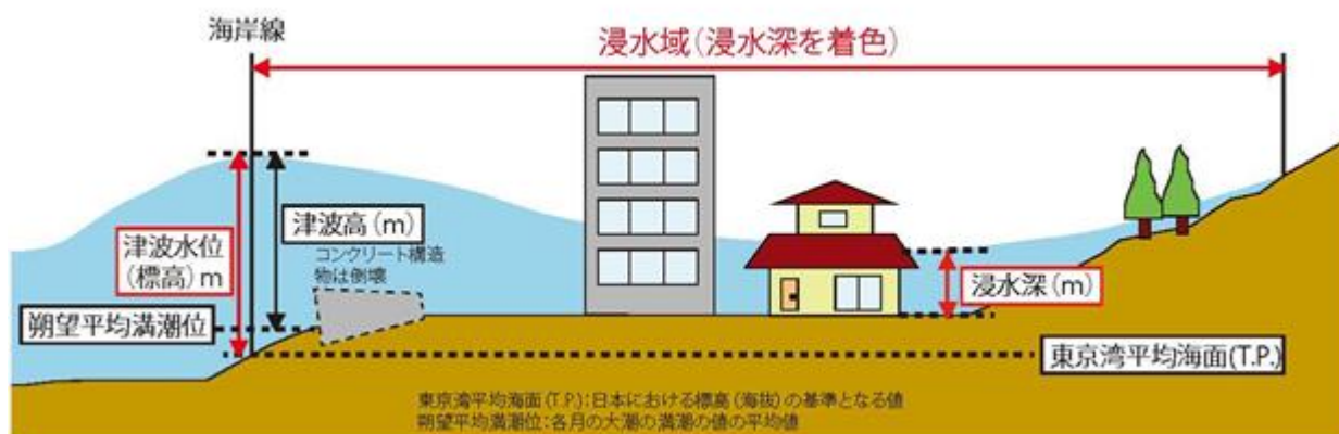
図3-1 津波高・浸水深のイメージ
