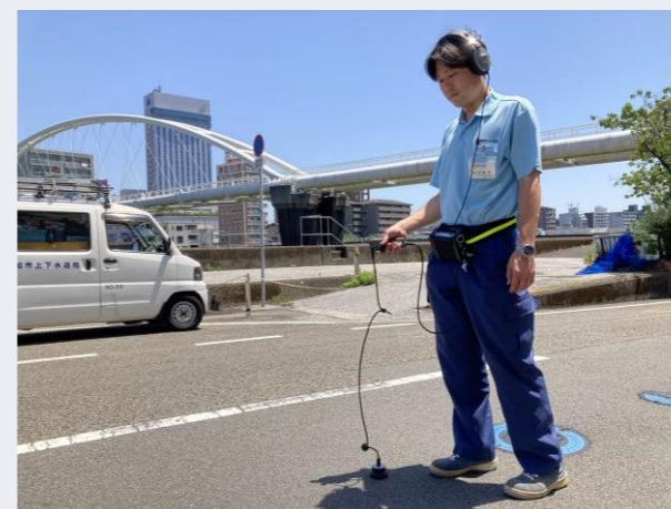
管路管理課 漏水探知器による漏水調査
