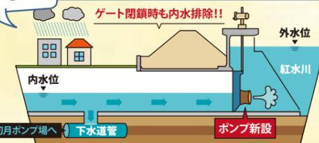
初月地区において、浸水被害を軽減するため補完ポンプを増設しました。大雨注意報で水門を閉鎖した場合でも、水路から水が溢れないように紅水川に排水します。
