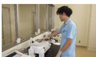
色度・濁度 （透過光測定法・積分球式光電光度法）
