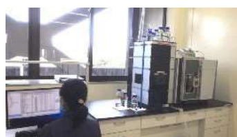
農薬類、PFOS及びPFOA （LC-MS/MS法）
