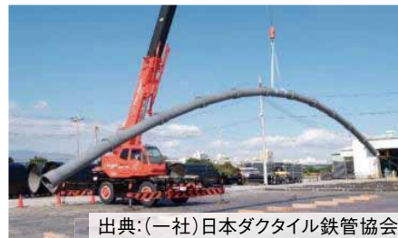
地震の揺れでも抜け出さない耐震管
