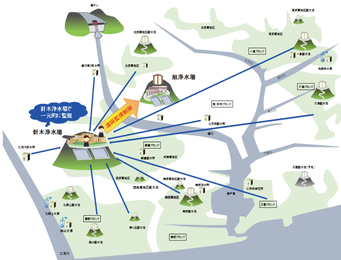
針木浄水場の集中監視制御イメージ
