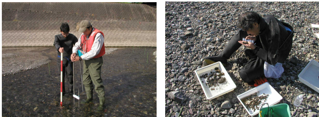
水深と流速の測定(左)および産着卵の計数状況(右)
