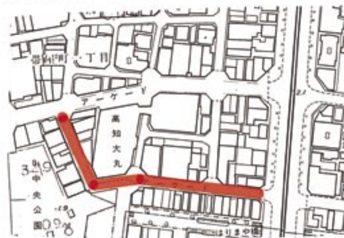
視覚障害者誘導ブロック敷設 L=360m
