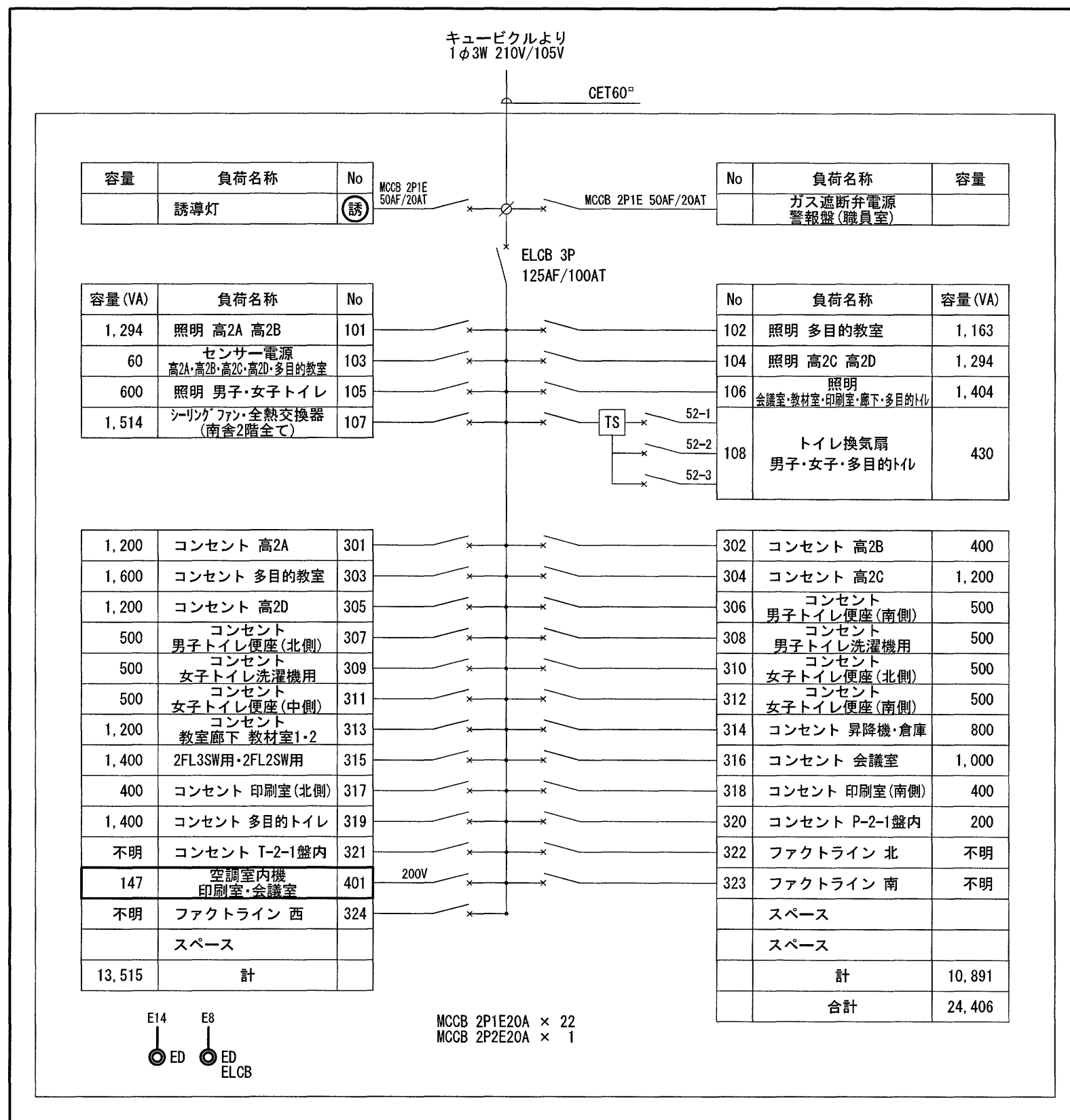
L-2-1盤 (半埋込型 銅板製 指定色) (南舎2階 印刷室)
