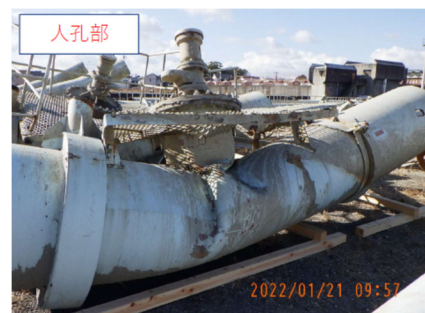
（座屈した空気弁付き人孔）
